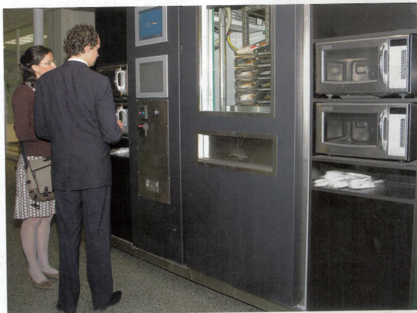
De Caterer, een gekoelde selfservice vending cateringwand met rechts de magnetrons voor opwarming van de maaltijden
